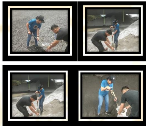
Gambar 1. Pengambilan Agregat di Quarry
