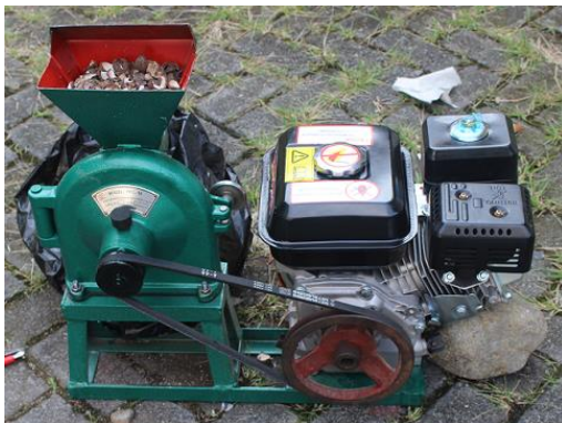
Gambar 1. Mesin Penggiling Cangkang Kemiri dan Tempurung Kelapa
