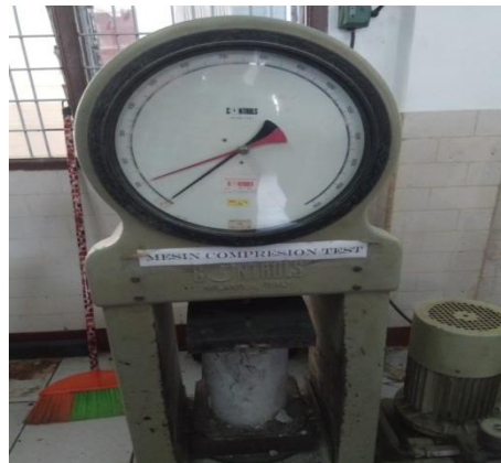
Gambar 5. Alat Pengujian Kuat Tekan Beton ( compression test )
