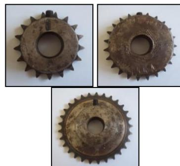
Gambar 11. Roda gigi pada *ripple mill* dengan diameter 3, 4 dan 5 inci
