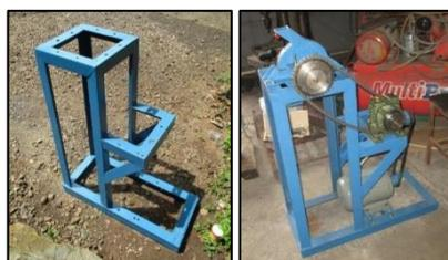
Gambar 4. Rangka dan pemecah biji kemiri sistem *ripple mill*
