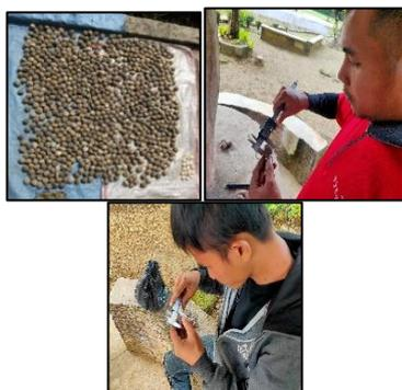
Gambar 6. Pengukuran Diameter Kemiri dengan Jangka Sorong
