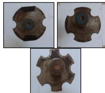
Gambar 10. Rotor bar dengan 2, 4 dan alur disesuaikan dengan diameter biji kemiri
