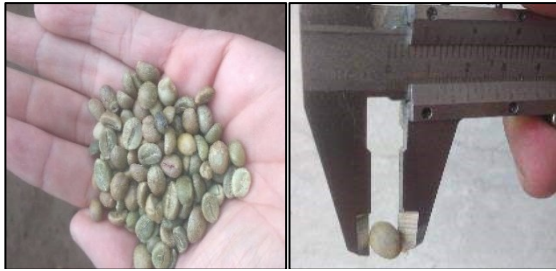
Gambar 6. Pengukuran Diameter Biji kopi dengan Jangka Sorong
