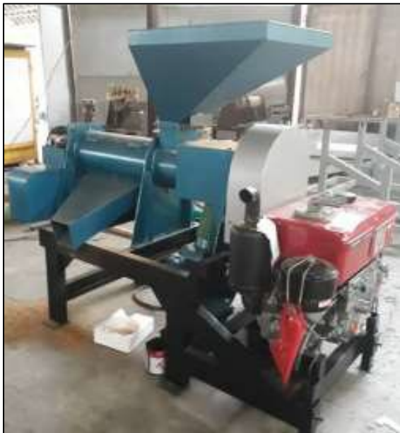
Gambar 1. Mesin Huller Kapasitas 200 kg/jam (Salim, 2023)
