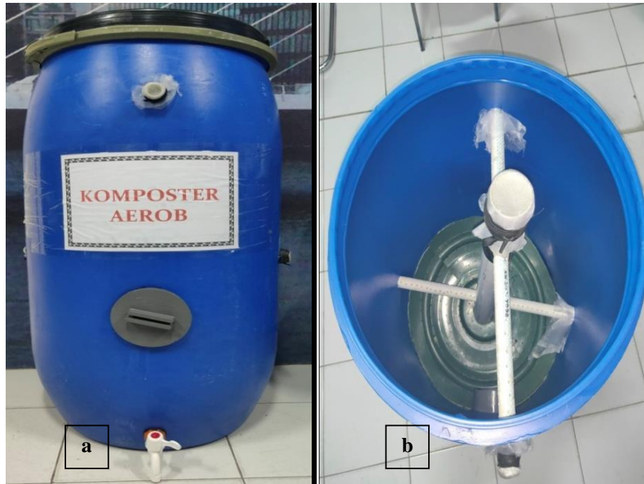
Gambar 4. Drum Komposter Aerob Sederhana a) Tampak Depan b) Tampak Dalam
