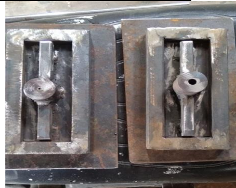
Gambar 2. Desain Mould Kampas Rem
