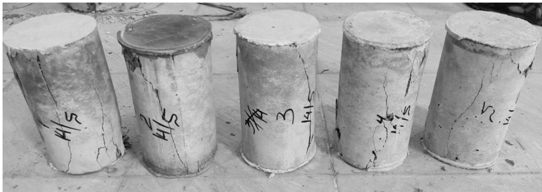
Gambar 4. Keruntuhan Benda Uji tidak terkekang
