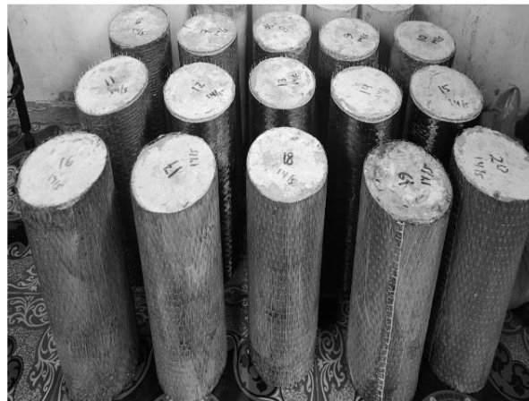
Gambar 2. Benda Uji setelah dipasang Carbon Fiber Wrap
