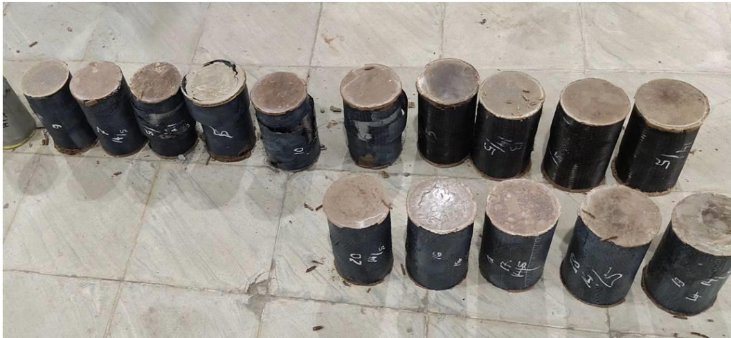
Gambar 4. Keruntuhan Benda Uji
