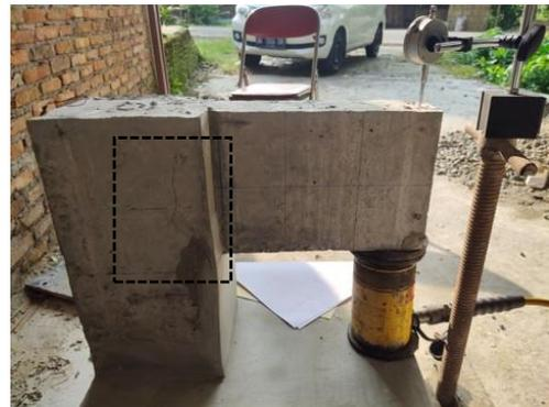
Gambar 7. Pola Runtuh Pengujian balok konsol dengan sengkang  $\phi 6-100$  mm
