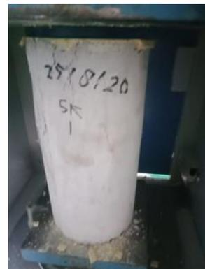
Gambar 5. Pengujian Kuat Tekan Beton Benda Uji Silinder.
