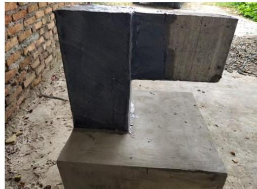
Gambar 9. Pola Runtuh Pengujian balok konsol dengan sengkang  $\phi 6-100$  mm
