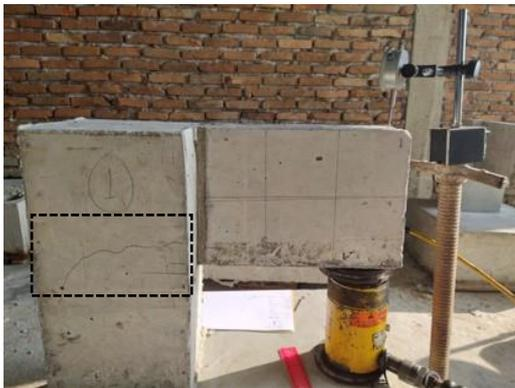
Gambar 6. Pola Runtuh Pengujian balok konsol dengan sengkang  $\phi 6-150$  mm
