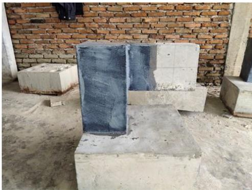
Gambar 8. Pola keruntuhan pada pengujian balok konsol dengan sengkang  $\phi 6-150$  mm
