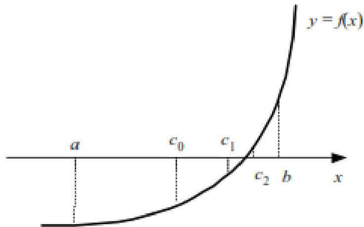
Gambar 2.2 Proses Pembagian selang  $[a, b]$  dengan metode bagi dua (Munir, 2006:67)
