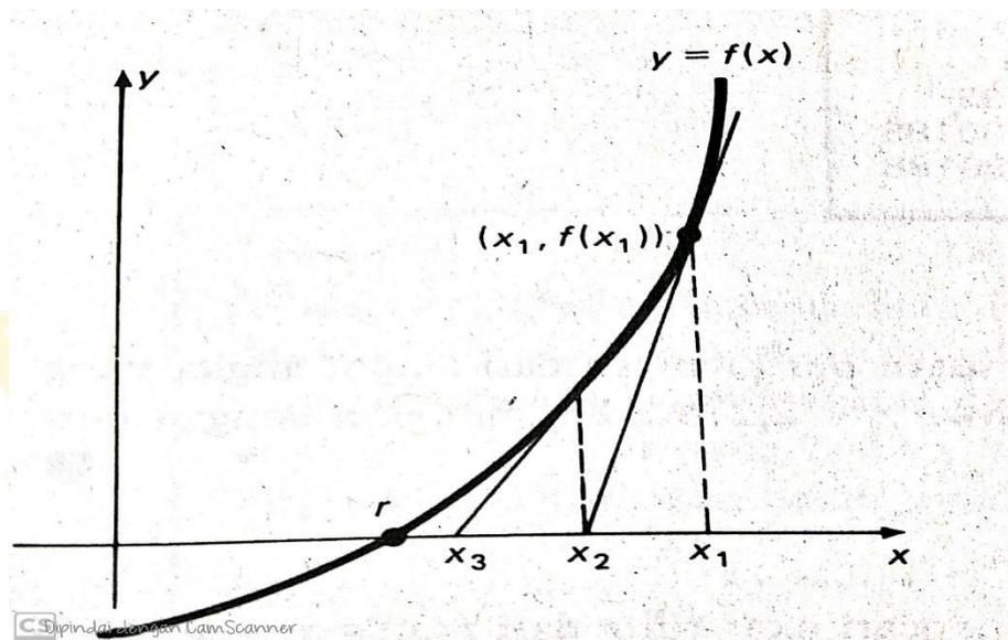
Gambar 2.4 Ilustrasi metode Newton Raphson (Purcell dan Varberg, 1984:499)
