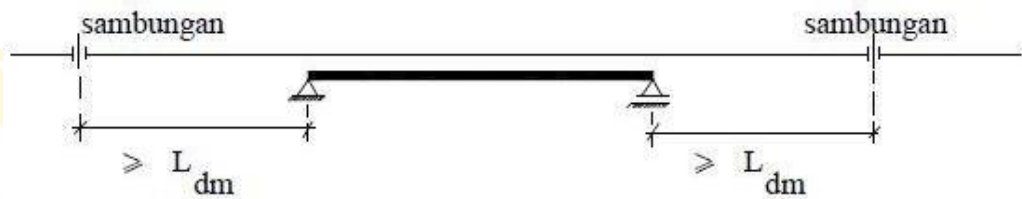
Gambar 2.12 Penempatan sambungan rel panjang yang melintasi jembatan
