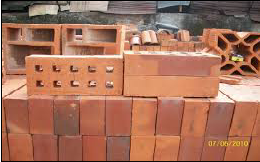
Gambar. 2.7. Batu bata dari tanah liat
