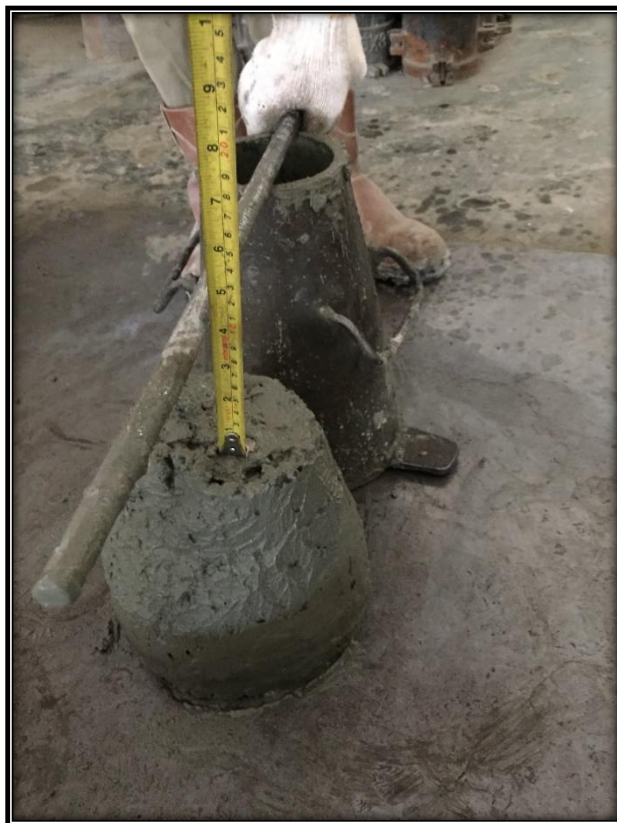
Foto 6: Pengukuran slump beton normal dan yang menggunakan campuran Naphthalene .
