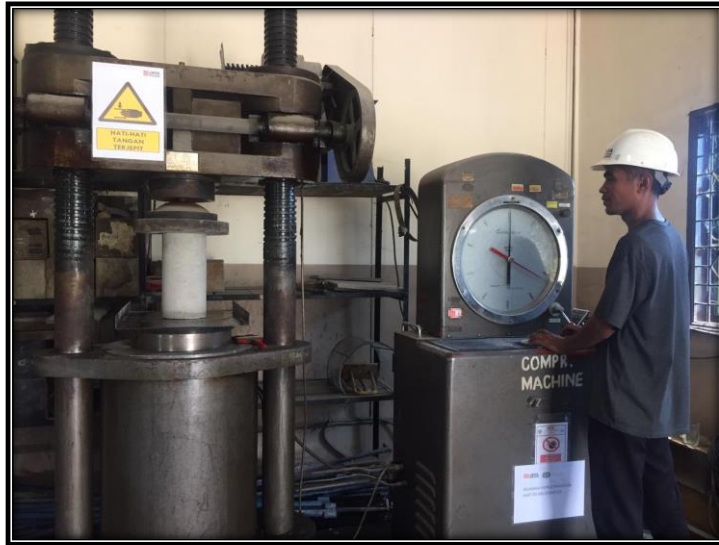
Foto 9: Proses pengujian kuat tekan beton.
