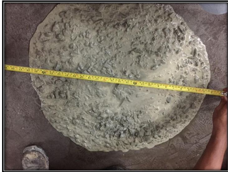
Lampiran 5: Foto Pengukuran slump beton yang menggunakan campuran Polycarboxylate memakai metode slump-flow .
