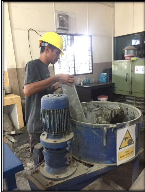
Foto 3: Proses pencampuran material beton.
