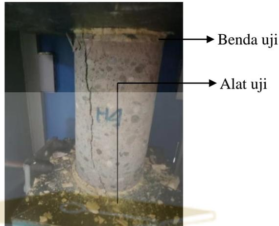
Gambar 2.2 Pengujian Pembebanan Terhadap Beton
