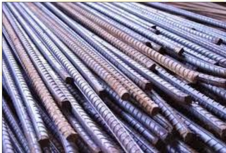
Gambar 2.6 baja tulangan beton sirip/ulir (Sumber : cvbilbelamanahjaya.com, 2013)
