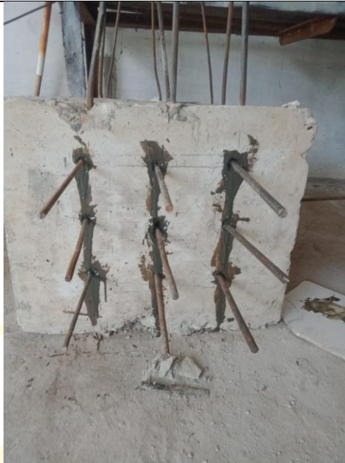
Gambar benda uji beton tulangan polos sebelum diuji tarik
