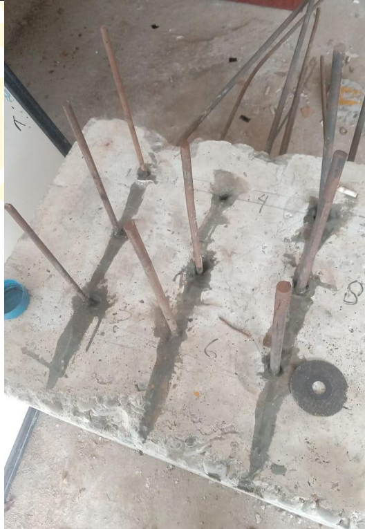
Gambar benda uji beton tulangan polos setelah diuji tarik
