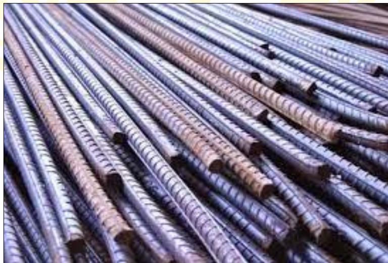
(Gambar 2.4 baja tulangan beton sirip/ulir) (Sumber : cvbilbelamanahjaya.com, 2013)
