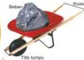
Gambar : Letak titik tumpu, beban, dan kuasa pada gerobak roda satu
