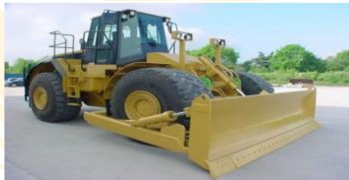
Gambar 2.2 Bulldozer dengan penggerak Wheel Tractor Dozer Sumber : PT.Global Mas Teknikindo,2023
