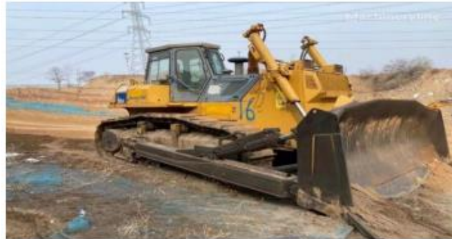
Gambar 2.1 Bulldozer dengan penggerak Crawler Tractor Dozer Sumber : PT.Global Mas Teknikindo,2023
