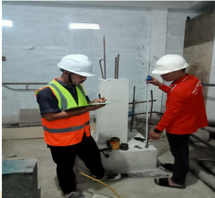
Pengukuran Panjang Rebar yang di Uji Tarik
