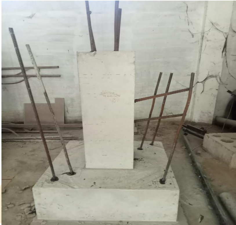
Benda uji setelah pengaplikasian rebar
