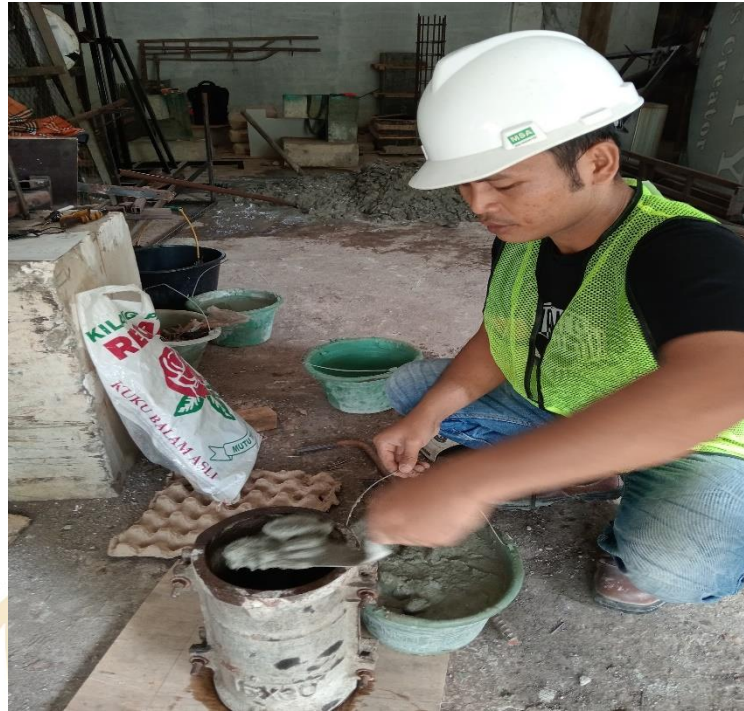
Pengecoran Benda Uji Silinder
