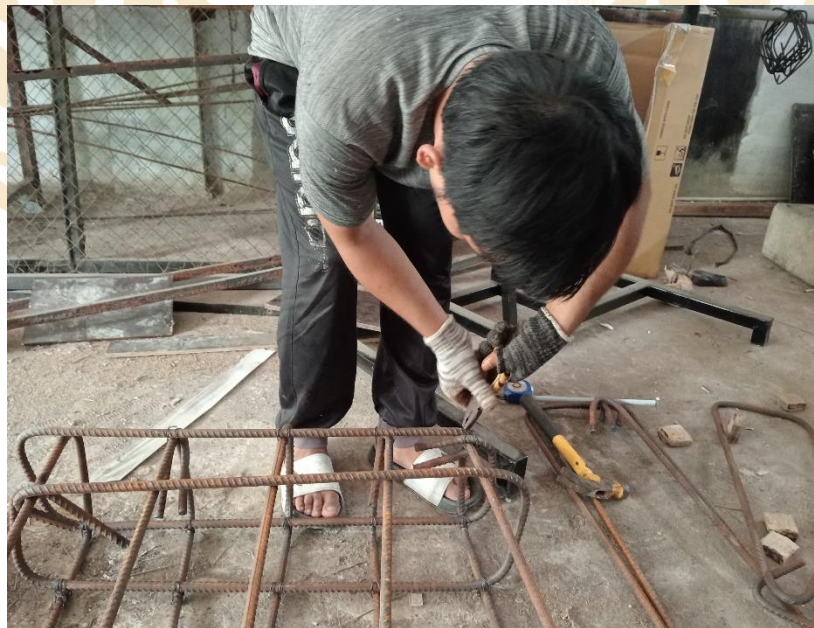
Perakitan besi tulangan pada benda uji
