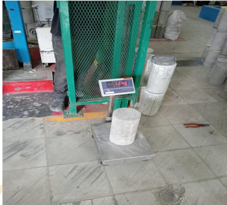
Penimbangan benda uji silinder
