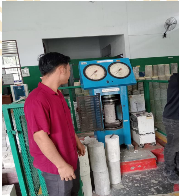
Pengujian Benda Uji Silinder
