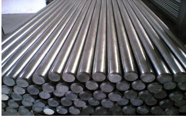
**Gambar 2.1 Besi Beton polos**
