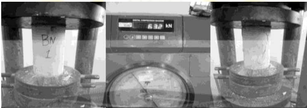
Gambar 2.5 Uji kuat tekan beton laboratorium Sumber : Boy Elyeser Ginting 2023
