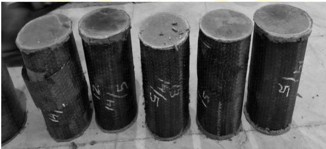
Gambar 2.3 Beton uji kuat tekan beton silinder dengan kekang carbon fiber wrap
