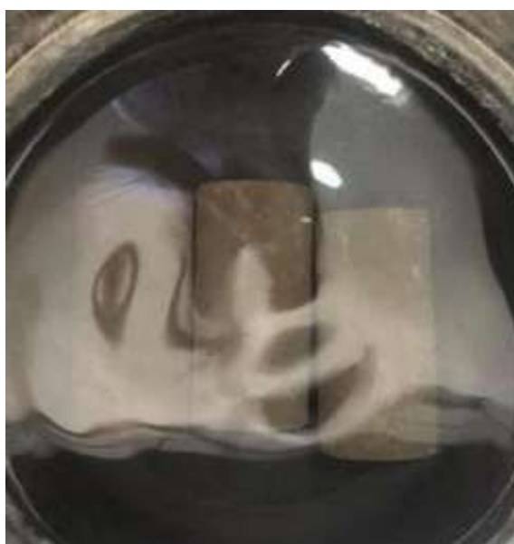
Gambar 2.9 Proses metode perawatan beton geopolymer dengan metode pembasahan dan tabel hasil kuat beton
