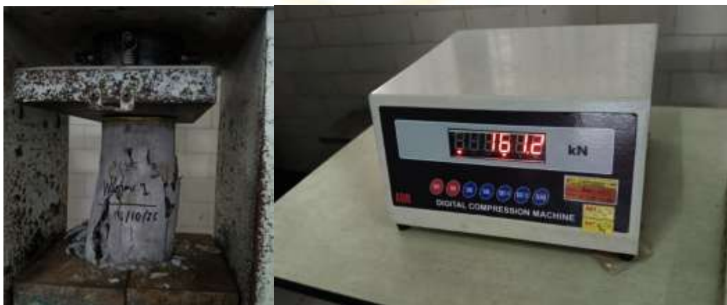
Uji kuat tekan beton
