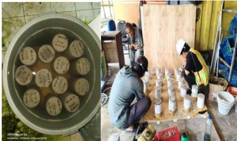
Mengeluarkan beton dari cetakan sekaligus perawatan ( curing ) beton
