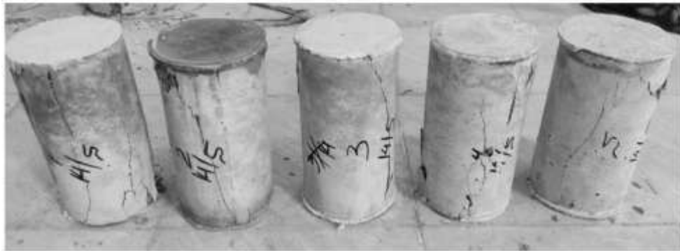
Gambar 2.8 Keruntuhan benda uji tidak terkekang Sumber: IPT Panggabean, VA Tarigan (2019)
