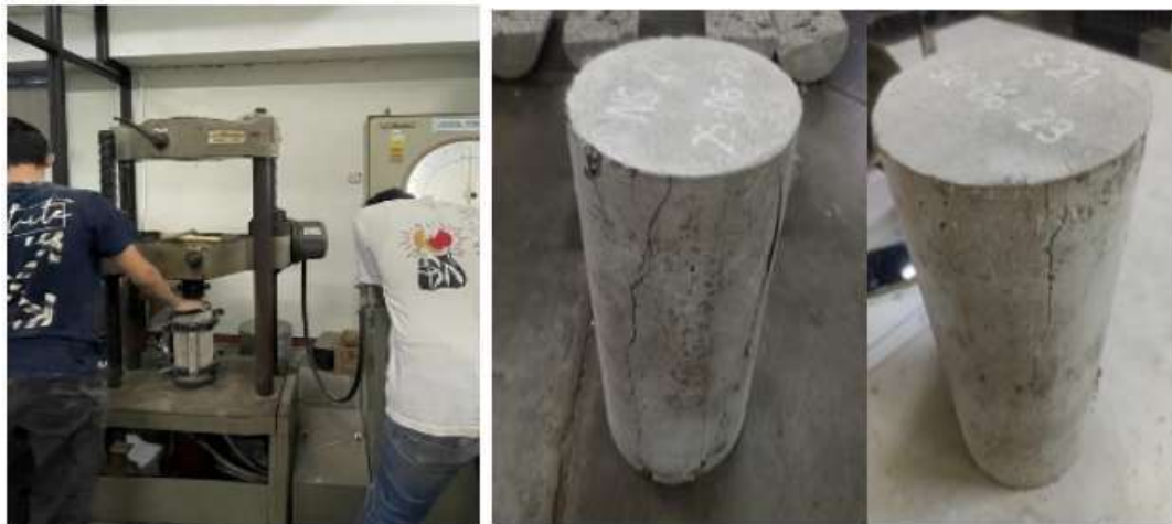
Gambar 2.14 Setup uji kuat tekan dan modulus elastisitas beton EPS dan Pola keruntuhan benda uji kuat tekan
