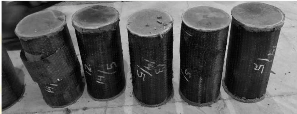
Gambar 2. 9 Beton uji kuat tekan beton silinder di kekang Carbon Fiber Wrap Sumber: IPT Panggabean, VA Tarigan (2019)
