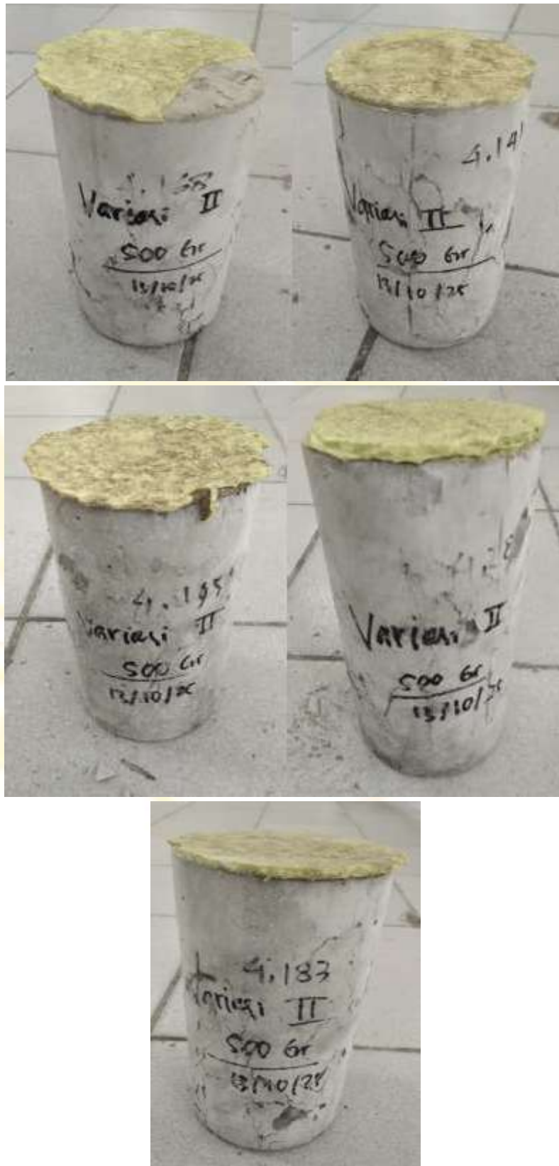
Pola retak variasi ke II
