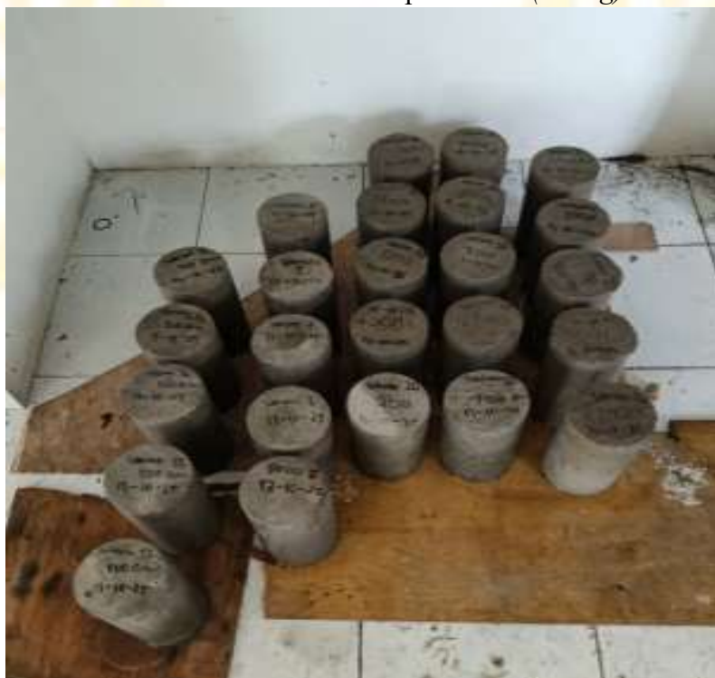
Beton di dikeluarkan dari perawatan ( curing )
