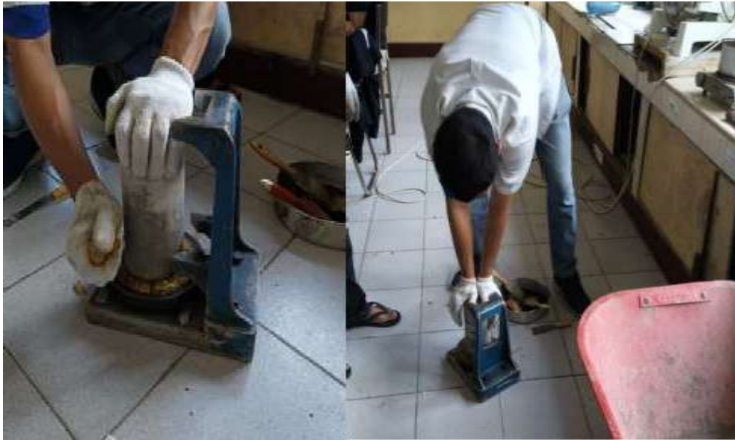
Proses capping beton silinder sebelum pengujian
