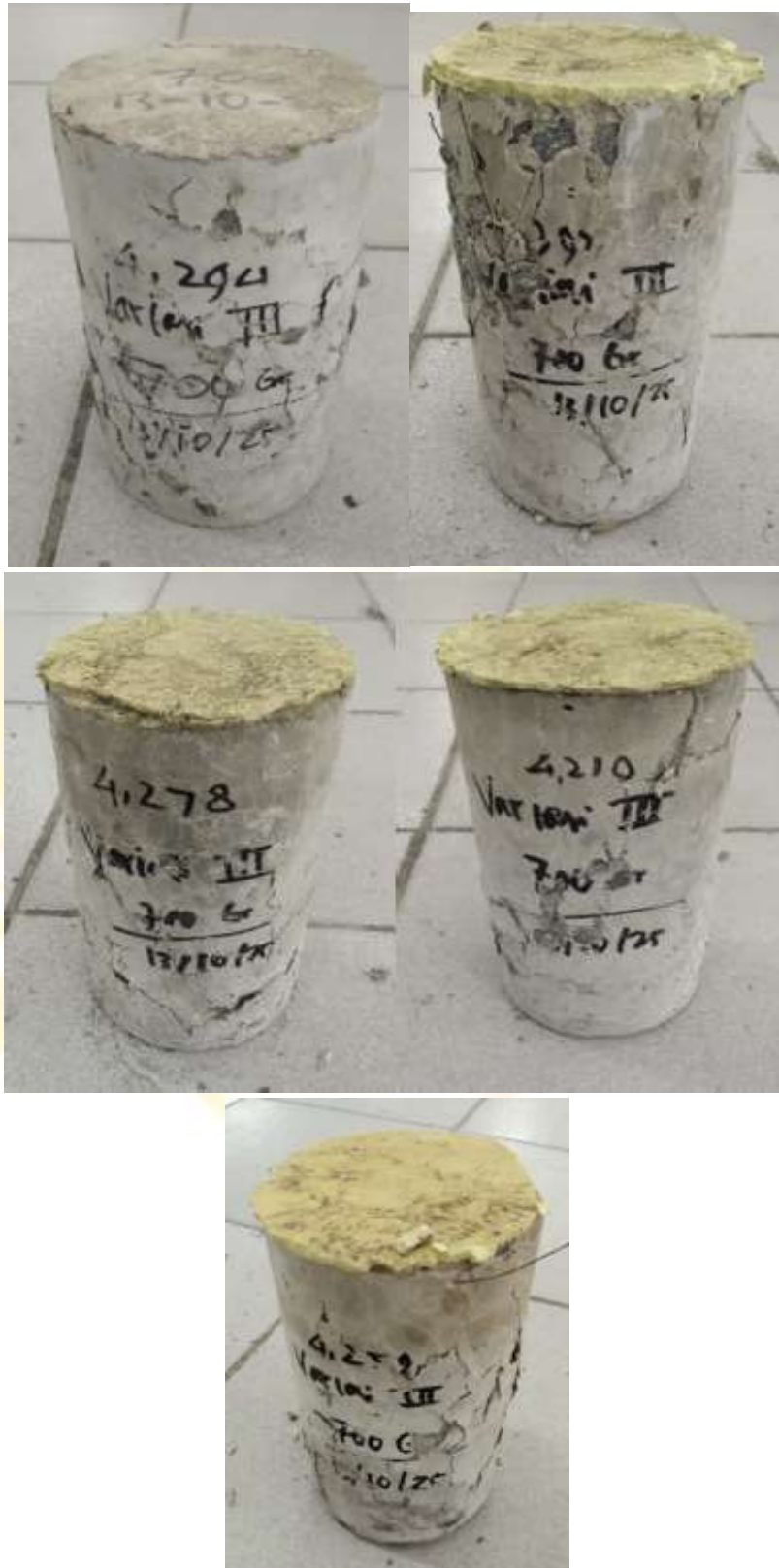
Pola retak variasi ke III
