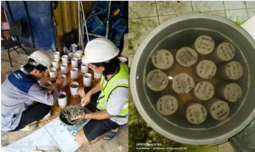
Pengecoran beton silinder sekaligus perawatan beton setelah beton di dikeluarkan dari cetakan
