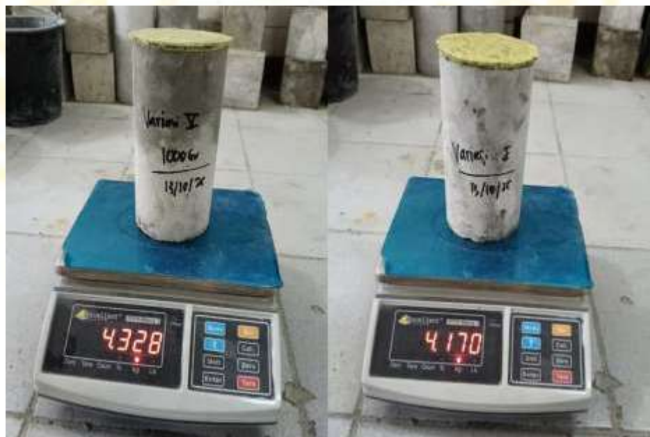
Timbangan berat sampel silinder sebelum pengujian
