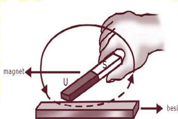
Gambar 2.6 Membuat Magnet Cara Gosokan
