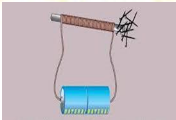
Gambar 2.5 Membuat Magnet Dengan Menggunakan Arus Listrik
