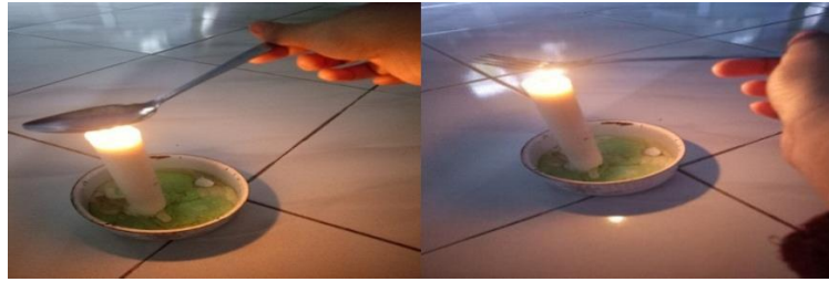
Gambar 2.1 contoh konduksi, sendok atau garpu yang dipanaskan diatas lilin yang menyala, maka akan terasa panas (sumber : dokumentasi pribadi)
